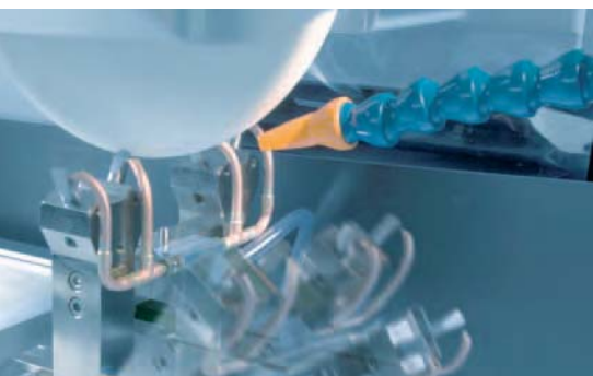
Klappbarer Doppel-Tischabrichter zur Aufnahme von 4 Profildiamanten
