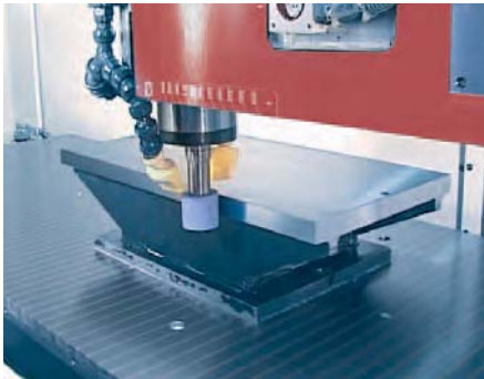
Vertikal-Zusatz-Schleifspindel, verschiebbar; 5 kW, max. 30.000 min -1
